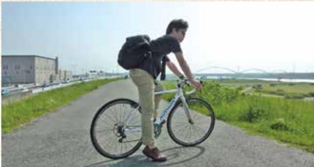
まず、私の愛車ですが、流行しているロードバイク（あるいはロードレーサー）とは少し毛色の異なるシクロクロスと呼ばれる自転車です。ロードバイクはアスファルトの路面で長距離（100km超）を速く走ることを目的としているのに対し、シクロクロスは砂浜、山の斜面等悪路を走ったり、中距離（100km以下）を走ったりすることを主眼に作られています。こういう自転車を専門に扱っているお店の人に、近場の買い物にも少し遠出もできる自転車はないのかと聞いて勧められたのが、このシクロクロスです。ロードバイクとの一番の違いはタイヤが細くないこと（シティサイクルよりも太い）と、ブレーキの機構が一昔前のマウンテンバイクのように少し頼りないことですが、走りはホンモノで推進力の力強さにびっくりしてしまいました。
